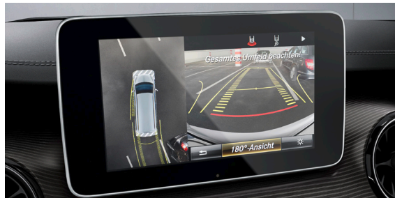
ระบบช่วยนำรถเข้าจอด Active Parking Assist พร้อมกล้องแสดงภาพแบบรอบทิศทางขณะถอยจอด สำหรับรุ่น V 220 d Avantgarde Premium
