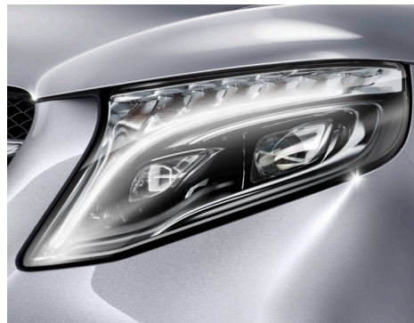
ไฟหน้าแบบ LED Intelligent Light System ทำงานและปรับลำแสงอัตโนมัติตามสภาพการขับขี่
