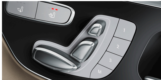
ที่นั่งคนขับ และผู้โดยสารด้านหน้าปรับด้วยระบบไฟฟ้า พร้อมหน่วยความจำ 3 ตำแหน่ง สำหรับรุ่น V 220 d Avantgarde Premium
